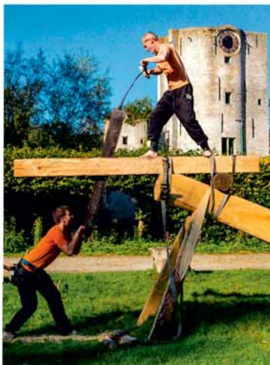
Planken zagen met de kraanzaag in de schaduw van het Prinsenkasteel. In het MOT gaan ontsluiting van de collectie en die van het bouwkundig erfgoed hand in hand
