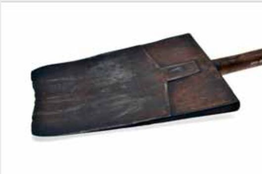
Vóór pakweg 1850 was **ijzer heel duur**. Toen werden veel werktuigen grotendeels **uit hout gemaakt**, zo ook schoppen en spades. Een houten spade is dan wel licht en stevig, zij snijdt niet zo goed in de aarde. Daarom werd er vaak een ijzeren beslag op de snijrand van het blad aangebracht, zo ging het langer mee.
