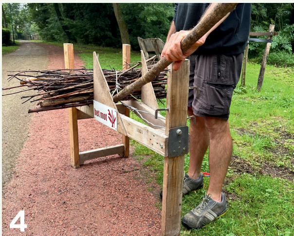
4 Steek de hefboom onder de takkenbos.
